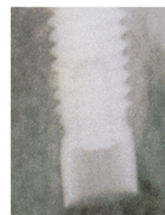
Ακτινογραφία του σπασμένου τμήματος της βίδας
