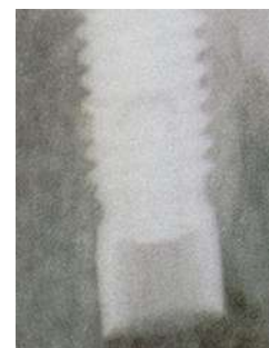
Ακτινογραφία του σπασμένου τμήματος της βίδας
